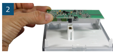
Zdemontuj pokrywę ciepłomierza i zainstaluj moduł ciepłomierzowy.
